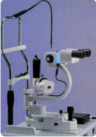
Figura 2. Lámpara de hendidura con sistema de iluminación por debajo del sistema de observación.
